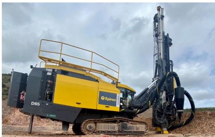
Рисунок 2.5 – Буровая установка Flexroc D65
