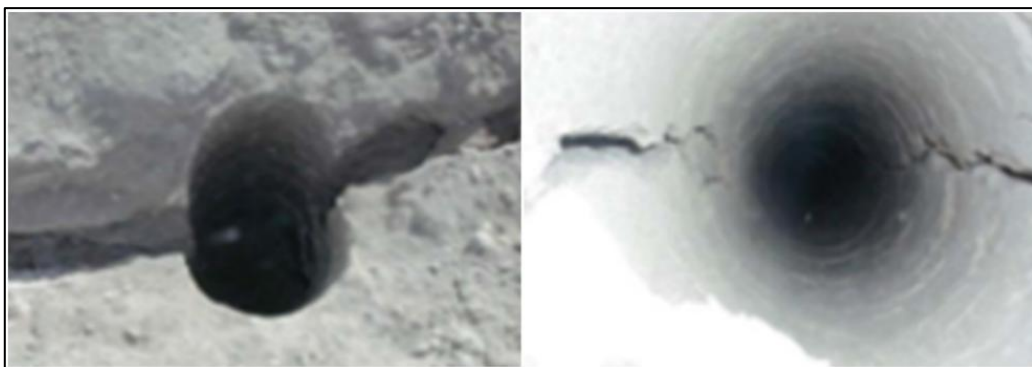
Рисунок 2.14 – Правильное образование щели между скважинами
