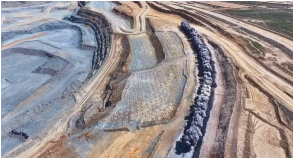
Рисунок 2.13 – Взрывные работы на скважинах предварительного щелеобразования
