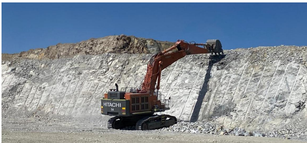
Рисунок 2.15 – Обзор на откос после отработки
