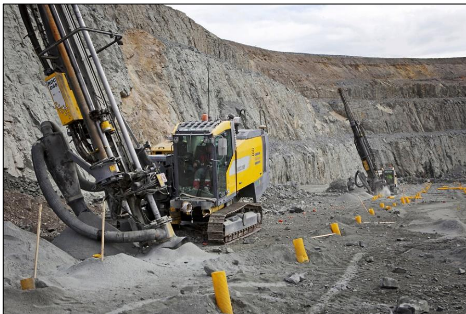
Рисунок 2.12 – Бурение скважин предварительного щелеобразования
