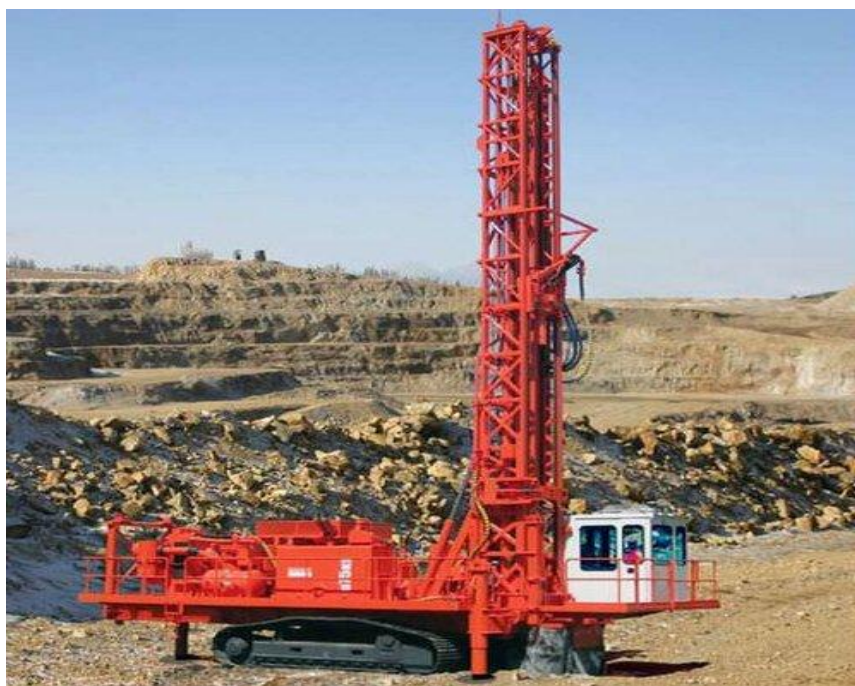
Рисунок 2.3 – Буровая установка Sandvic D55SPR
