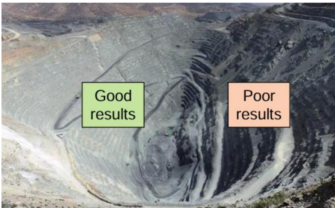
Рисунок 2.24 – Результат постановки борта в конечное положение
